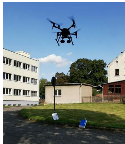
Vorführung des Multikopters für Gebäude- und Objektdiagnostik
